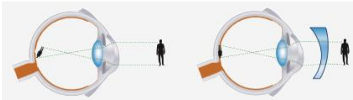
Şekil: Astigmat göz ve bunun silindirik mercekle düzeltilmesi
