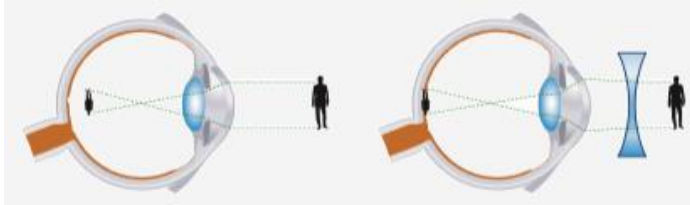
Şekil: Miyop göz ve bunun kalın kenarlı mercekle düzeltilmesi
